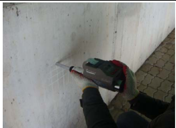
반발경도법에 의한 비파괴 강도시험
