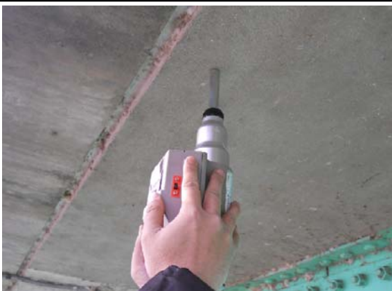
반발경도법에 의한 비파괴 강도시험
